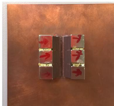
(b) *Sicht von oben auf den kompletten Aufbau mit Neodym Magneten. Die Magnete wurden zusammengeklebt, doch sie stoßen sich so stark ab, dass sich recht große Lücken zwischen ihnen bilden.*
