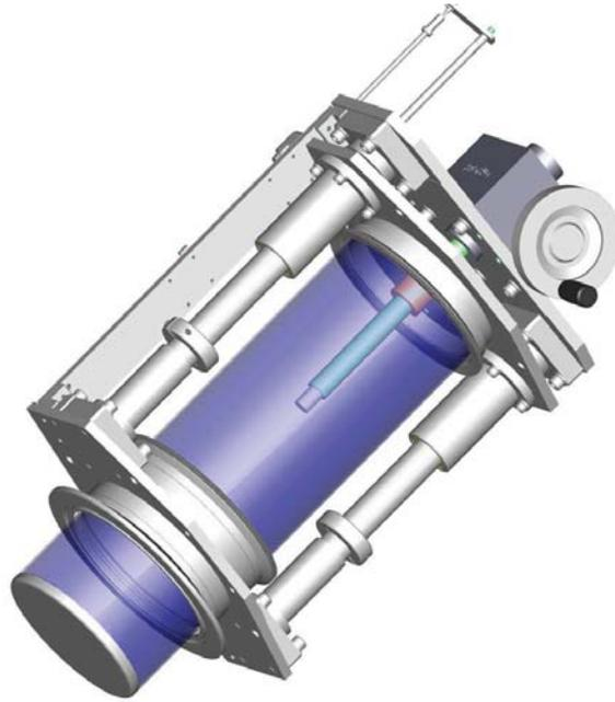
Abbildung 2.4: Geometrie des Stempeltuners zur Verstimmung der Resonanzfrequenzen der 208 MHz Kavität. Der Stempeltuner wird in einen der vorhandenen Flansche der Kavität eingebaut. Der Stempel mit einem Durchmesser von 146 mm kann bis zu 110 mm in die Kavität eingefahren werden.
