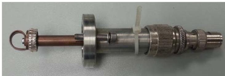
Abbildung 2.3: Magnetisch gekoppelte Pickupantenne.
