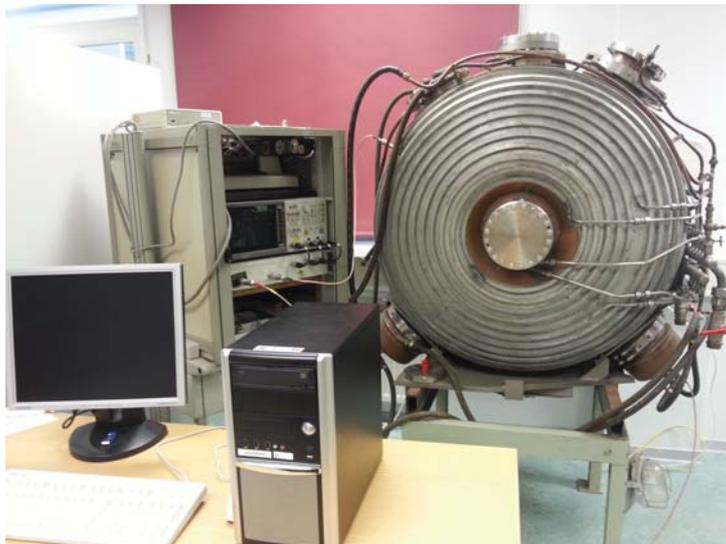
Abbildung 2.1: WISPDMX Aufbau mit der 208 MHz Kavität im Labor des Institut für Experimentalphysik. An der Kavität sind an den Flanschen rechts und links unten die HOM-Koppler montiert; am oberen rechten Flansch die Antenne, durch die das HF-Signal für den Beschleunigerbetrieb eingekoppelt wurde. Diese Komponenten sowie leicht entfernbare Teile der Wasserkühlung wurden inzwischen für den WISPDMX-Einsatz entfernt.
