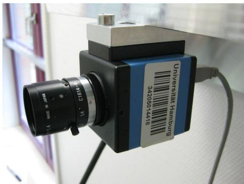
Abbildung 3.4: CCD - Kamera DMK 31AU03.AS mit USB-Verbindung. Die Abbildung zeigt die Kamera bereits an den Spiegel montiert. Die Stromversorgung der Kamera erfolgt über das USB-Kabel.
