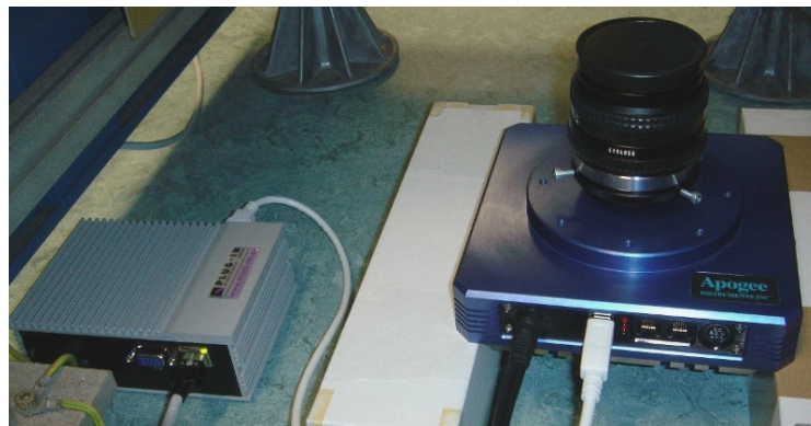
Abbildung 4.1: Das CCD-Kamerasystem im Labor. Im Bild links ist der MiniPC zu sehen, an den die USB-Kamera angeschlossen ist. Die USB-Kamera (rechts) steht auf zwei Klötzen erhöht, damit eine ausreichende Luftzirkulation durch die an der Unterseite angebrachten Lüfter gewährleistet ist. Zudem ist ein Testobjektiv aufgeschraubt.
