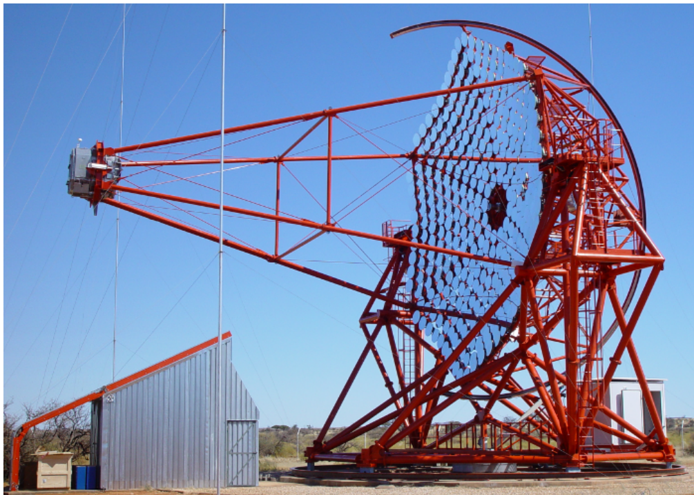
Abbildung 2.2: Nahaufnahme eines H.E.S.S.-Teleskops: Zu sehen ist die rote Stahlkonstruktion, rechtsseitig die 380 Spiegelfacetten in der Reflektorebene ( dish ) und links die Hauptkamera, die durch die vier Stahlarme in der Fokalebene gehalten wird. Unten rechts ist die weiße Elektronikhütte ( electronic hut ) zu sehen, in der die Kabelverbindungen vom Teleskop zusammenlaufen und sich diverse Steuerungseinheiten befinden. Diese steht auf der Teleskopkonstruktion und dreht sich somit mit. Links unten befindet sich eine Schutzhütte, in der die empfindliche Hauptkamera tagsüber untergebracht ist – die Parkposition der Teleskope. [Photo: H.E.S.S.-Kollaboration]
