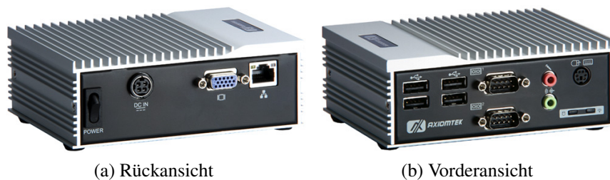
Abbildung 3.2: Der MiniPC: Die eBOX530-830-FL von zwei Seiten mit ihren verschiedenen Anschlüssen. Man sieht außerdem das silberne Gehäuse mit der Struktur des passiven Kühlelements. [Photos: www.plug-in.de ]
