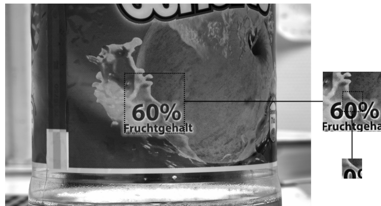
Abbildung 4.4: Teilauslese des CCD-Chips. Das große Bild zeigt eine Vollbildaufnahme (1536 x 1024 Pixel), davon abgehend eine Aufnahme mit einer Größe von 300 x 300 Pixel und eine Aufnahme mit 100 x 100 Pixel.
