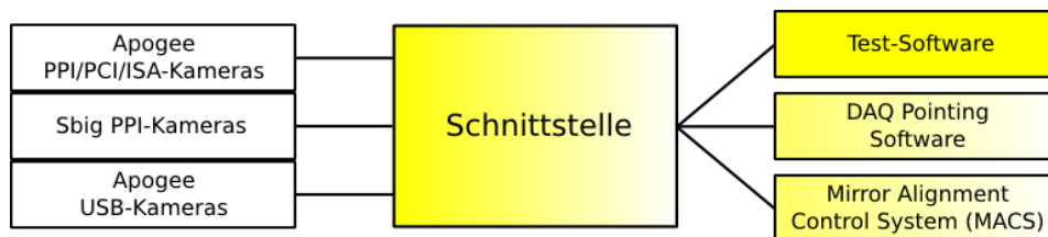
Abbildung 4.2: Schema der CCD-Kameraschnittstelle für H.E.S.S.: Links deuten die drei Boxen die Treiber für die verschiedenen Kameras an, auf die die Schnittstelle zugreift. Die Treiber für die Apogee USB-Kameras wurden in dieser Arbeit in die Schnittstelle (Mitte) implementiert. Rechts sind die unabhängigen Programme exemplarisch aufgelistet, die jeweils die Schnittstelle benutzen, um auf eine CCD-Kamera zuzugreifen. Das Testprogramm wurde im Rahmen dieser Arbeit geschrieben (Gelb). Ein Gelbverlauf in den anderen Boxen deutet an, dass diese Komponente wegen der neuen Kamera verändert bzw. angepasst werden muss. [Zeichnung nach Petz (2002)]
