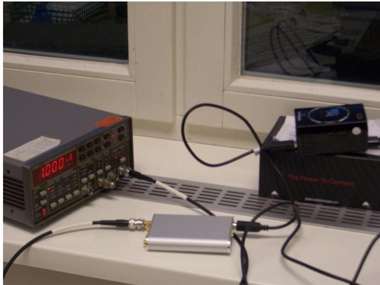
Abbildung 3.4: Der Aufbau zur Messung der Ereignisrate
