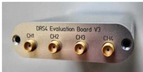
Abbildung 3.2: Das DRS4-Board (Bild: PSI [2])
