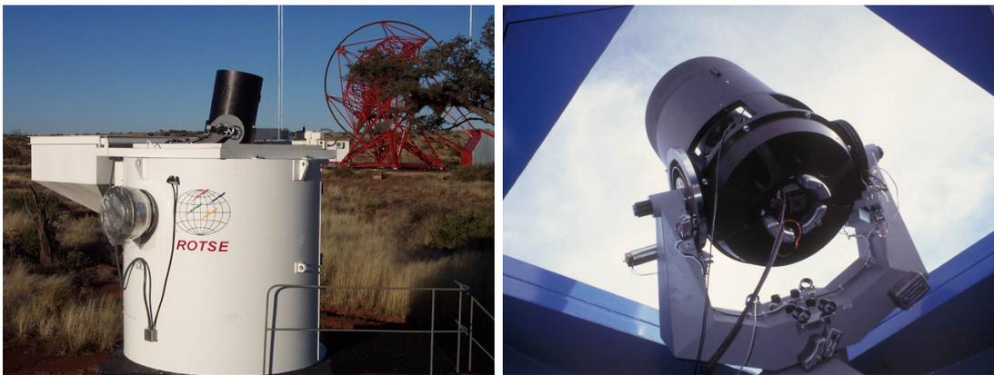
Abbildung 2.4: ROTSE-III-Teleskop. Links: ROTSE-IIIs Gehäuse mit geöffneter Abdeckung. Das Foto stammt aus Akerlof *et al.* (2003). Rechts: Das Teleskop im inneren des Gehäuses. Dieses Foto stammt von der ROTSE-Internetseite (<http://www.rotse.net/>).
