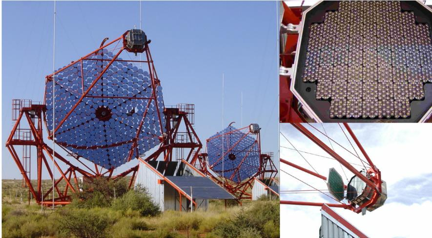
Abbildung 3.7: Links: zwei der vier H·E·S·S·-Teleskope. Rechts oben: die Photomultiplier-Kamera mit den *Winston-Kegeln* als Aufsatz zur besseren Ausleuchtung der einzelnen Photomultiplier durch Fokussierung der einfallenden Photonen; die Anordnung in 60 *Drawer* ist ebenfalls zu erkennen. Rechts unten: geöffneter Verschluss der Kamera, die an der Stahlhalterung (rot) in der Fokalebene angebracht ist.
