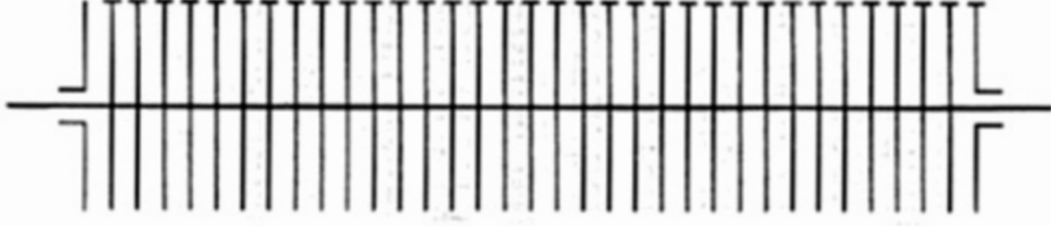
Fig. 13.18 Viele auf einem langen Draht aufgereihete Drehpendel bilden eine Pendelkette (Seitenansicht)
